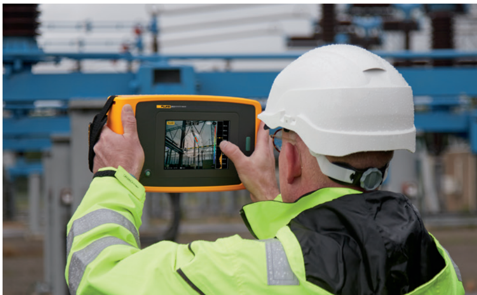
Bild tagen med ii910 Precision Acoustic Imager som upptäcker partiell urladdning vid högspänningsanvändning.
