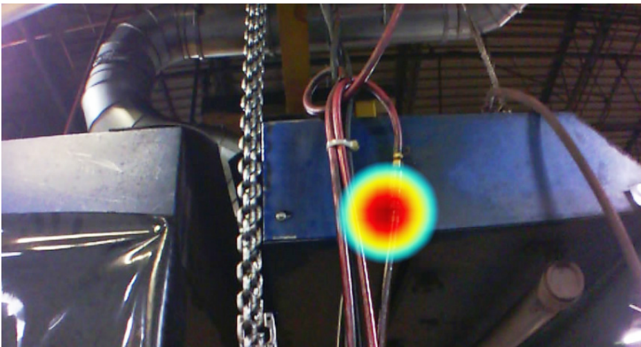
Bild tagen med ii900 Industrial Acoustic Imager av ett luftläckage i industriell miljö.
