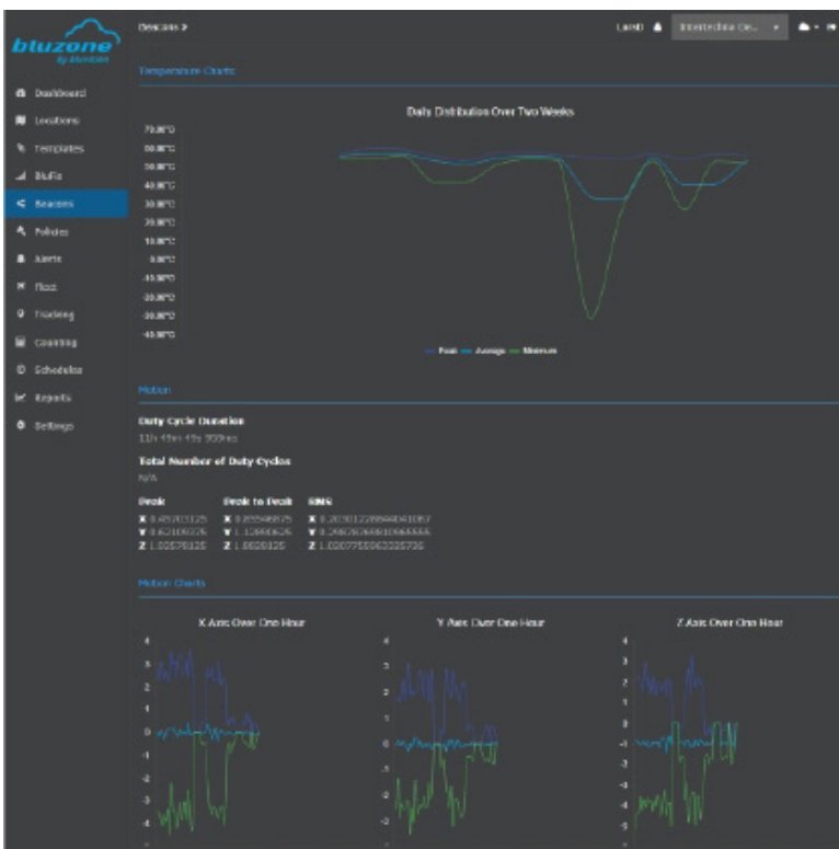
Översikt på signaler från maskin med bland annat vibrationer och temperatur
